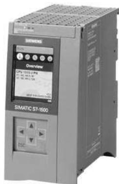
SIMATIC S7-1500, CPU 1515-2 PN, CPU avec 1 Mo de mémoire de travail pour le programme et 4,5 Mo pour les données, 1ère interface : PROFINET IRT avec commutateur 2 ports, 2ème interface : PROFINET RT, performance sur bit 6 ns, SIMATIC Memory Card nécessaire \*\*\* respecter les homologations et les certificats conformément à la contribution 109817466 sur [support.industry.siemens.com](http://support.industry.siemens.com) ! \*\*\*
