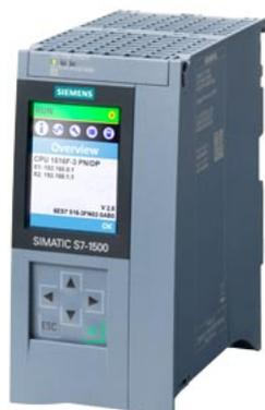
SIMATIC S7-1500F, CPU 1516F-3 PN/DP, unité centrale avec 1,5Mo de mémoire de travail pour le programme et 5Mo pour les données, 1ère interface : PROFINET IRT avec commutateur 2 ports, 2ème interface: PROFINET RT, 3ème interface: PROFIBUS, performance sur bit 10 NS, carte mémoire SIMATIC nécessaire
