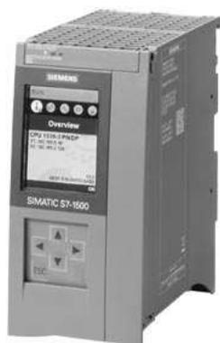
SIMATIC S7-1500, CPU 1516-3 PN/DP, CPU avec 2 Mo de mémoire de travail pour le programme et 7,5 Mo pour les données, 1ère interface : PROFINET IRT avec commutateur 2 ports, 2ème interface : PROFINET RT, 3ème interface : PROFIBUS, performance sur bit 6 ns, SIMATIC Memory Card nécessaire \*\*\* respecter les homologations et les certificats conformément à la contribution 109817466 sur support.industry.siemens.com ! \*\*\*
