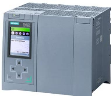
SIMATIC S7-1500, CPU 1517T-3 PN/DP, Module unité centrale avec 3 Mo de mémoire de travail pour le programme et 8 Mo pour les données, 1. interface : PROFINET IRT avec commutateur 2 ports, 2ème interface, Ethernet, 3ème interface, PROFIBUS, performance sur bit 2 NS, carte mémoire SIMATIC nécessaire
