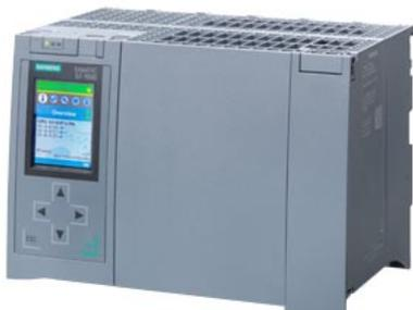
SIMATIC S7-1500H, CPU 1518HF-4 PN, module unité centrale avec 9 Mo de mémoire de travail pour le programme et 60 Mo pour les données, 1ère interface : PROFINET RT, avec commutateur 2 ports, 2ème interface : PROFINET, 3ème interface : PROFINET, 4ème/5ème interface : H-SYNC, SIMATIC Memory Card nécessaire
