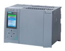
SIMATIC S7-1500H, CPU 1518HF-4 PN, module unité centrale avec 9 Mo de mémoire de travail pour le programme et 60 Mo pour les données, 1ère interface : PROFINET RT, avec commutateur 2 ports, 2ème interface : PROFINET, 3ème interface : PROFINET, 4ème/5ème interface : H-SYNC, SIMATIC Memory Card nécessaire
