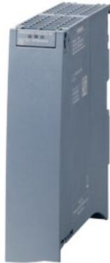
SIMATIC S7-1500, module d'entrées TOR, DI 64x 24V CC SNK/SRC BA, 64 voies par groupes de 16, retard d'entrée type 3,2ms, type d'entrée 3 (CEI 61131) ; lecture P/M, 35mm de large, câbles et embase à commander séparément comme accessoires
