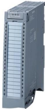
SIMATIC S7-1500, module d'entrée TOR DI 16xNAMUR HF, 16 voies par groupes de 8 ; pour codeur NAMUR 8,2V ; alimentation du capteur 8,2V; retard d'entrée; paramétrable 0,05 ... 20ms; fonction de comptage intégrée jusqu'à 20 kHz prolongation d'impulsion ; surveillance de flottement ; diagnostic d'inversion de signal; alarmes de processus ; tous les composants requis pour le blindage sont fournis ; connecteur frontal (bornes à vis ou push-in) à commander séparément
