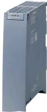
SIMATIC S7-1500, module de sorties TOR, DQ 64x24V DC/0,3A BA, 64 voies par groupes de 16, 2A par groupe à 60°C, écriture P, 35mm de large, le module prend en charge la coupure de sécurité de groupes de charge jusqu'à SIL2 selon EN IEC 62061:2021 et Category 3 / PL d selon EN ISO 13849-1:2015. câbles et embase à commander séparément comme accessoires
