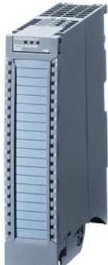
SIMATIC S7-1500, module de sorties TOR DQ 8x24V CC/2A HF ; 8 voies par groupes de 8; 8A par groupe ; diagnostic ; valeur de remplacement : 2 vois utilisables pour la modulation de largeur d'impulsions(MLI). Le module prend en charge la coupure de sécurité de groupes de charge jusqu'à SIL2 selon EN IEC 62061:2021 et Category 3 / PL d selon EN ISO 13849-1:2015. connecteur frontal (bornes à vis ou push-in) à commander séparément
