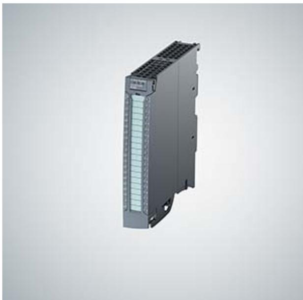
SIMATIC S7-1500 MODULE ENTREE/SORTIE TOR, DI16X24VCC, 16 CANAUX EN GROUPE DE 16, RETARD ENTREE TYPIQUE 3,2MS TYPE D'ENTREE 3 (CEI 61131), DQ16X24VCC / 0,5A; 16 CANAUX EN GROUPE DE 8; 4A PAR GROUPE INCL. CONN. FRONTAL PUSH-IN
