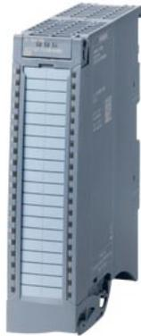
SIMATIC S7-1500, module d'entrées analogiques, AI 16xU BA, résolution 16 bits, précision 0,5%, 16 voies par groupes de 16, tension de mode commun 4 V CC, diagnostic, alarmes de processus ; livré avec élément d'alimentation, étrier de blindage, et borne de blindage : connecteur frontal (bornes à vis ou Push-in) à commander séparément
