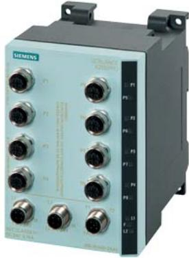
SCALANCE X208PRO, managed IE Switch, 8 ports 10/100 Mbit/s M12, IP65/67, diagnostic LED, contact de signalisation de défaut, alimentation redondante, périphérique PROFINET IO, gestion de réseau, utilisable en anneau redondant, capuchon anti-poussière, incl. manuel électronique sur CD-ROM, C-PLUG en option.
