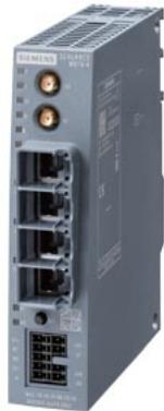
routeur 4G SCALANCE M876-4 ; pour la communication IP sans fil d'automates programmables via LTE téléphonie mobile (4G), optimisé pour une utilisation mondiale, VPN, pare-feu, NAT ; commutateur à 4 ports; 2x antennes SMA, technologie MIMO ; 1x entrée TOR, 1x sortie TOR; respecter les homologations nationales !
