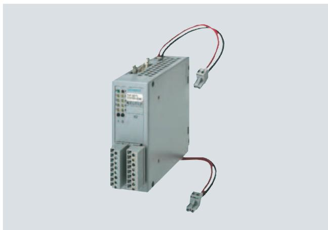
Le module d'interface sert au raccordement de 8 sorties TOR avec conversion transistorisée de la tension 24 V CC du côté module à une tension max. de 24/48 V CC du côté installation.
