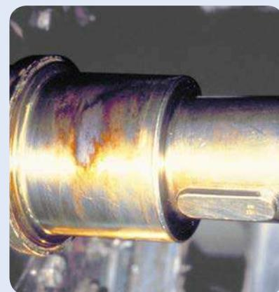
L'agent SKF LGAF 3E est une pâte lisse et grasse protégeant contre la rouille de contact provoquée par des oscillations très légères ou des vibrations qui peuvent compliquer sérieusement le démontage.
