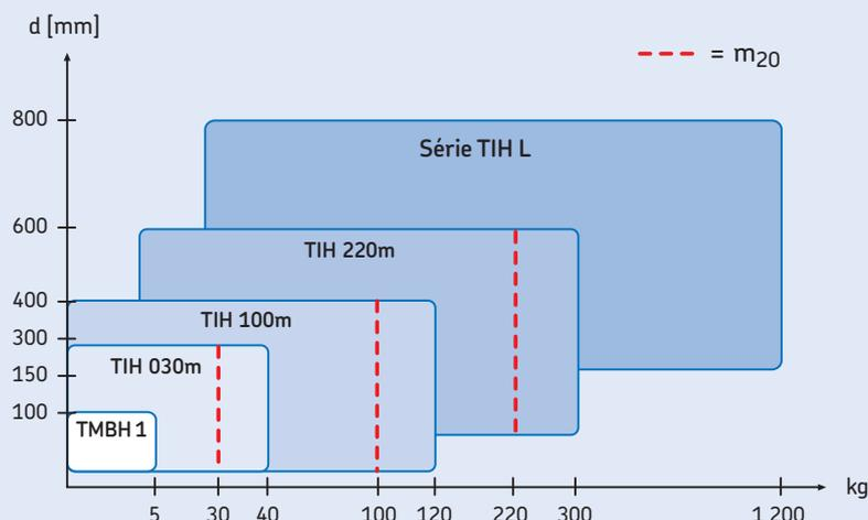
La large gamme d'appareils de chauffage par induction SKF convient à la plupart des applications de chauffage de roulements. Le tableau présente des informations générales sur le choix d'un appareil de chauffage par induction pour les roulements.<sup>3)</sup>
