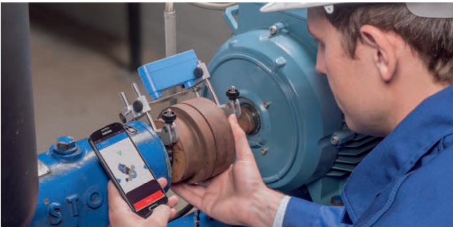
L'alignement d'arbres est une procédure recommandée pour pratiquement toutes les industries, car il permet d'améliorer de manière significative la disponibilité des machines et de réduire les coûts de maintenance. Le TKSA 11 permet aux clients de réaliser des économies d'échelle grâce à un alignement d'arbres effectué dans les règles de l'art.
