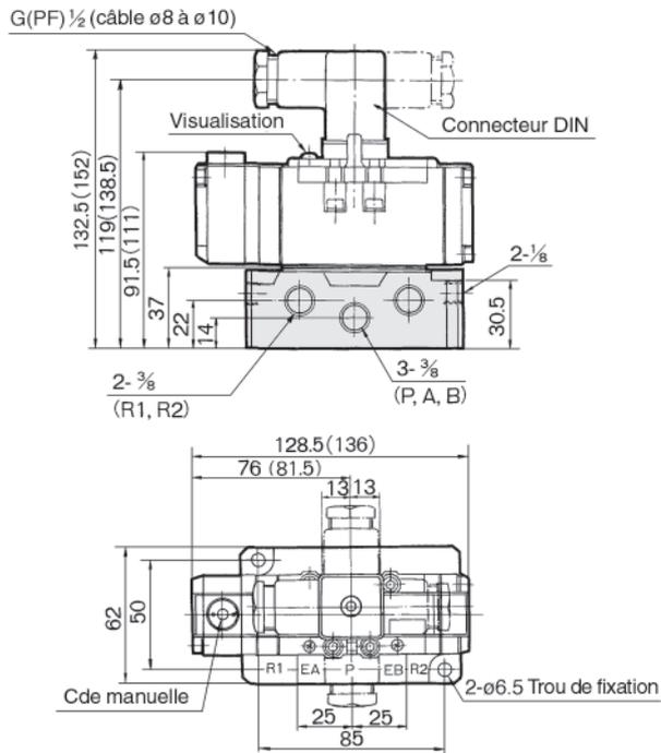
**VS7-6-FG-D-□□ Orifice de l'embase -Q**
