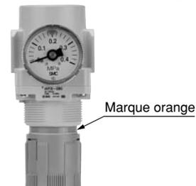
3. Pour régler la pression à l'aide de la bague, tournez-la pour augmenter la pression et bloquez la bague une fois la pression réglée.
