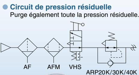
Par sécurité, la pression résiduelle peut être évacuée côté sortie lorsque l'alimentation en air est coupée et que la pression intérieure est évacuée dans l'atmosphère.
