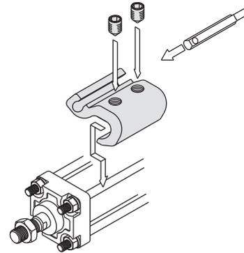
\* La figure ci-dessus fournit un exemple de montage des modèles D-M9□(V)/M9□W(V)/M9□A(V)/A9□(V).
