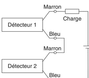
Si deux détecteurs sont connectés en série, un dysfonctionnement peut se produire car la tension de charge chute en position ON. Les indicateurs lumineux s'allument si les deux détecteurs sont en position ON. L'utilisation de détecteurs de tension de charge inférieure à 20 V est impossible.
