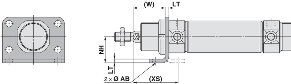
**Équerre double : C□75E□ - □SM (Avec fixation de montage)**
