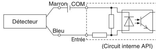
Effectuez le raccordement conformément aux spécifications d'entrée de l'API compatible, car la méthode de branchement varie en fonction des caractéristiques d'entrée de l'API.
