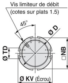
Montage sur collier (B) Sans détection magnétique
