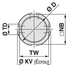
Montage sur collier (B) Sans détection magnétique
