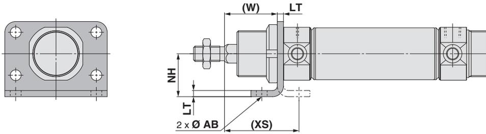
Équerre double : C□75KE□ - □SM (Avec fixation de montage)
