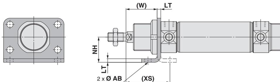
Équerre double : C□75E□ - □M (Avec fixation de montage)
