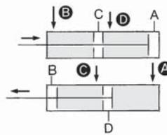
Lors de la pressurisation des orifices **B** et **D**, la force de sortie est doublée dans la course de rentrée.
