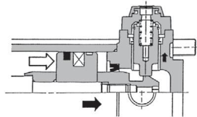
3. Le piston de verrou est poussé vers le haut dans la rainure de la tige de piston pour le verrouiller. (Le piston de verrou est poussé vers le haut par la force du ressort.) À cet instant, il est évacué de l'orifice avant et introduit dans l'atmosphère.
