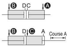
Lors de la pressurisation des orifices **A** et **B**, les courses A et B se rétractent.
