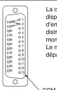
La combinaison de câblage monostable et bistable est disponible en option. Le nombre maxi de stations d'embase est déterminé par le nombre de distributeurs. Comptez un point pour un modèle monostable et deux points pour un modèle bistable. Le nombre total de distributeurs (points) ne doit pas dépasser 24.
