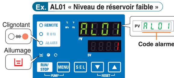
**Codes alarme signalant les temps d'inspection.**
