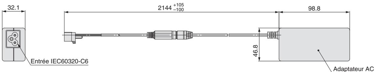
\* : Les côtés entrée (AC) et sortie (DC) de l'adaptateur AC ne sont pas isolés.
