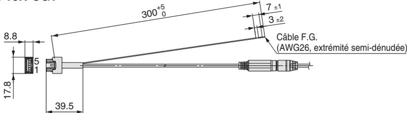
Câble F.G. (AWG26, extrémité semi-dénudée)
