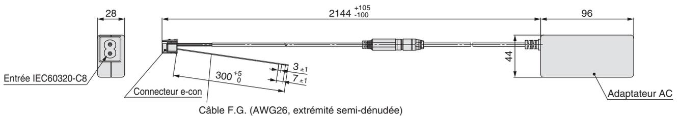
Câble F.G. (AWG26, extrémité semi-dénudée)
