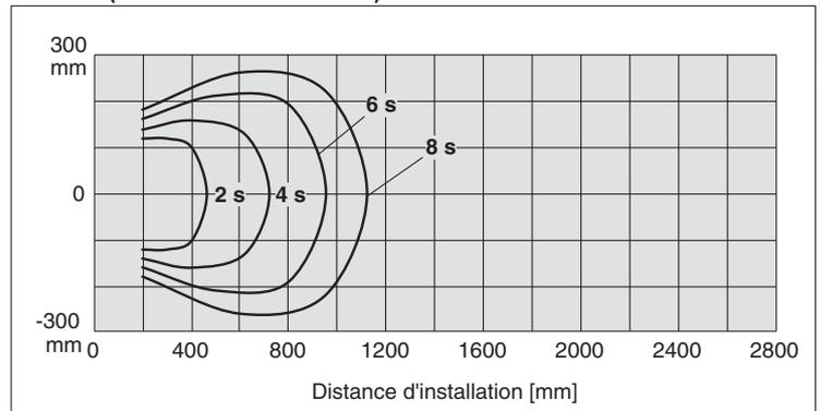
**IZF21-W (Avec louvre réglable : Paramètre d'angle 1, Niveau du débit d'air : 10)**
