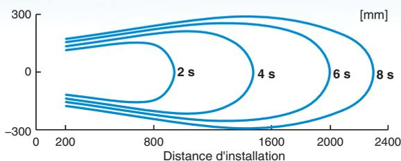
Lors de la neutralisation de l'électricité statique de 1000 V à 100 V à une distance de 300 mm de la pièce (surface avant). Lorsque le débit d'air de l'IZF31 est au maximum.
