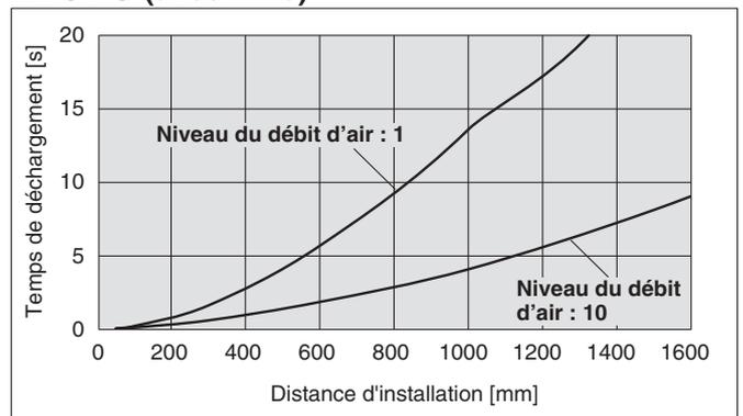
Note) Les performances de neutralisation d'électricité statique se basent sur les données provenant de l'utilisation d'une plaque chargée (dimensions : 150 mm x 150 mm, capacité : 20 pF) tel que défini dans les normes EN 61340-5-1:2007. Ceci vise uniquement à vous guider dans le choix du modèle car la valeur varie en fonction du matériau et/ou de la dimension des objets.
