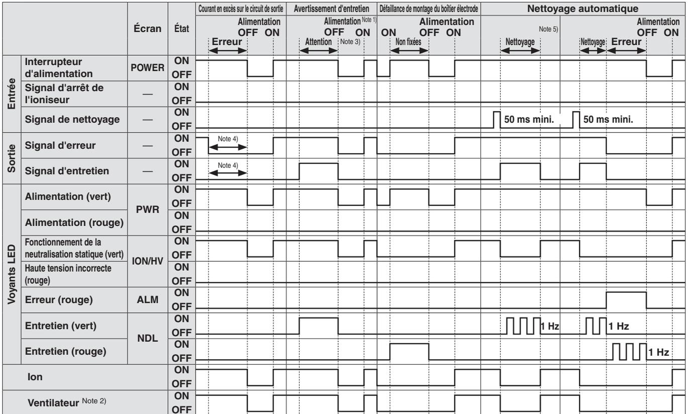
Note 1) Les avertissements de tension élevée incorrecte, dysfonctionnement du moteur du ventilateur et entretien peuvent également être émis par le signal d'arrêt de l'ioniseur après la résolution de l'erreur.
