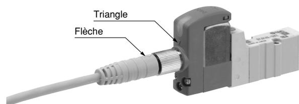
Note) Le câble de connecteur doit être monté dans le bon sens. Assurez-vous que la flèche figurant sur le connecteur se trouve face au triangle figurant sur la vanne si vous utilisez le câble de connecteur SMC (V100-49-1-□). Evitez de le presser dans la mauvaise direction au risque d'endommager la broche.
