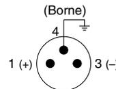
Schéma électrique de la broche du côté de l'électrovanne (Pour le modèle W)
