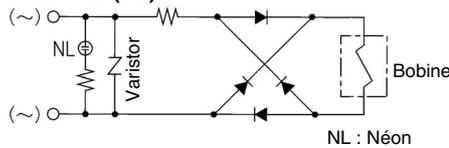
Note) La protection de circuit du varistor a tension résiduelle correspondant à l'élément de protection et à la tension nominale ; par conséquent protégez le côté contrôleur des surtensions. La tension résiduelle de la diodes est d'environ 1 V.
