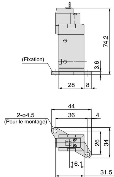
Connecteur encliquetable (L) : SYJ7□2-□L□□□-01□ (-F)-Q    Connecteur encliquetable (M) : SYJ7□2-□M□□□-01□ (-F)-Q    Connecteur DIN (D) : SYJ7□2-□D□□□-01□ (-F)-Q    Connecteur M8 (WO) : SYJ7□2-□WO□□□-01□ (-F)-Q
