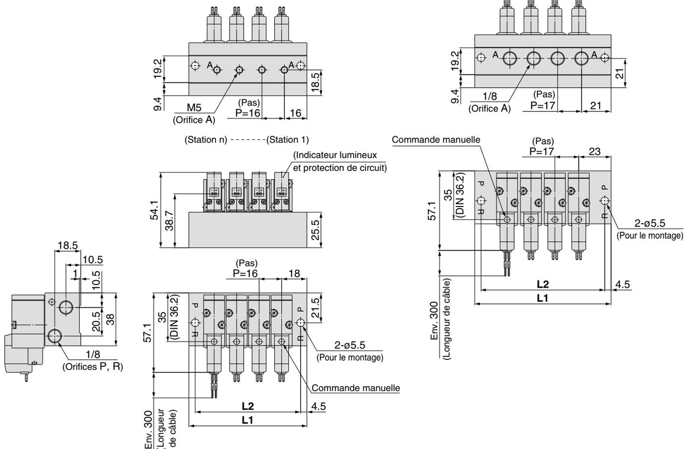
Connecteur encliquetable (L)    Connecteur encliquetable (M)    Connecteur DIN (D)    Connecteur M8 (WO)
