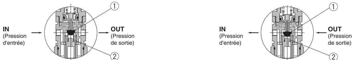
Lorsque la pression à l'admission est supérieure à la pression de réglage, le clapet antiretour fonctionne comme un régulateur normal (Figure 1).
