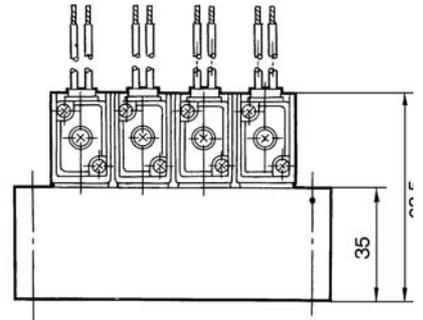
Note) Pour plus de 9 stations, alimentez à partir de l'orifice P des deux côtés de l'embase et évacuez à partir de l'orifice R des deux côtés de l'embase.
