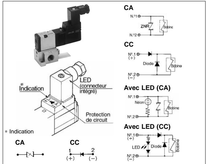
Pour un câblage en CC, connectez le bornier n°1 du connecteur sur le pôle positif [+], et le n° 2 sur le pôle négatif [-].
