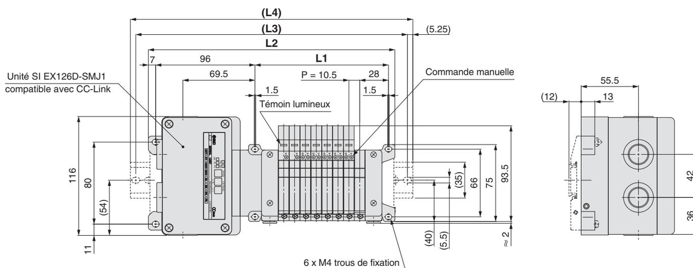
Les lignes en pointillés indiquent le montage sur rail DIN [-D] (avec fixation de montage pour rail DIN).
