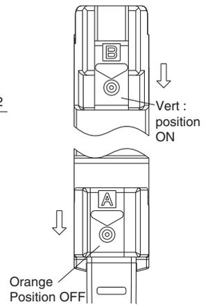
On verrouille la commande manuelle en la faisant coulisser sur toute la longueur vers le côté du distributeur (côté ON) avec un petit tournevis à tête plate ou un doigt. Faites-la glisser vers le côté du raccord (côté OFF) pour la libérer. Il est également possible de l'utiliser comme modèle à poussoir avec un tournevis de  $\phi 1.7$  maxi. ( $\phi 2$  maxi. pour VQ2000).
