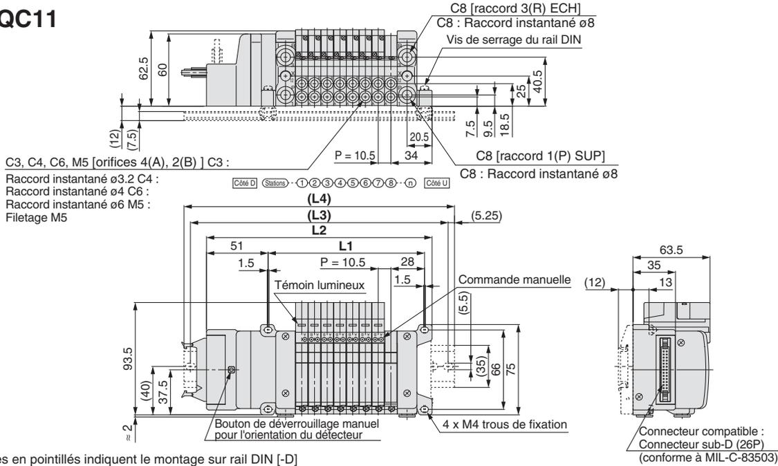
Les lignes en pointillés indiquent le montage sur rail DIN [-D] (avec fixation de montage pour rail DIN).
