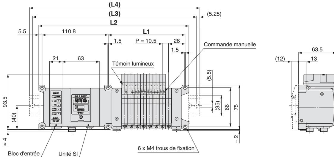
Les lignes en pointillés indiquent le montage sur rail DIN [-D] (avec fixation de montage pour rail DIN).
