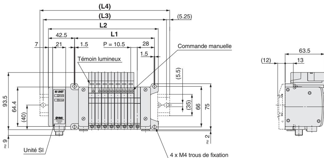
Les lignes en pointillés indiquent le montage sur rail DIN [-D] (avec fixation de montage pour rail DIN).
