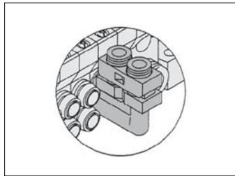
**Fixation de montage du rail DIN [-D]**
