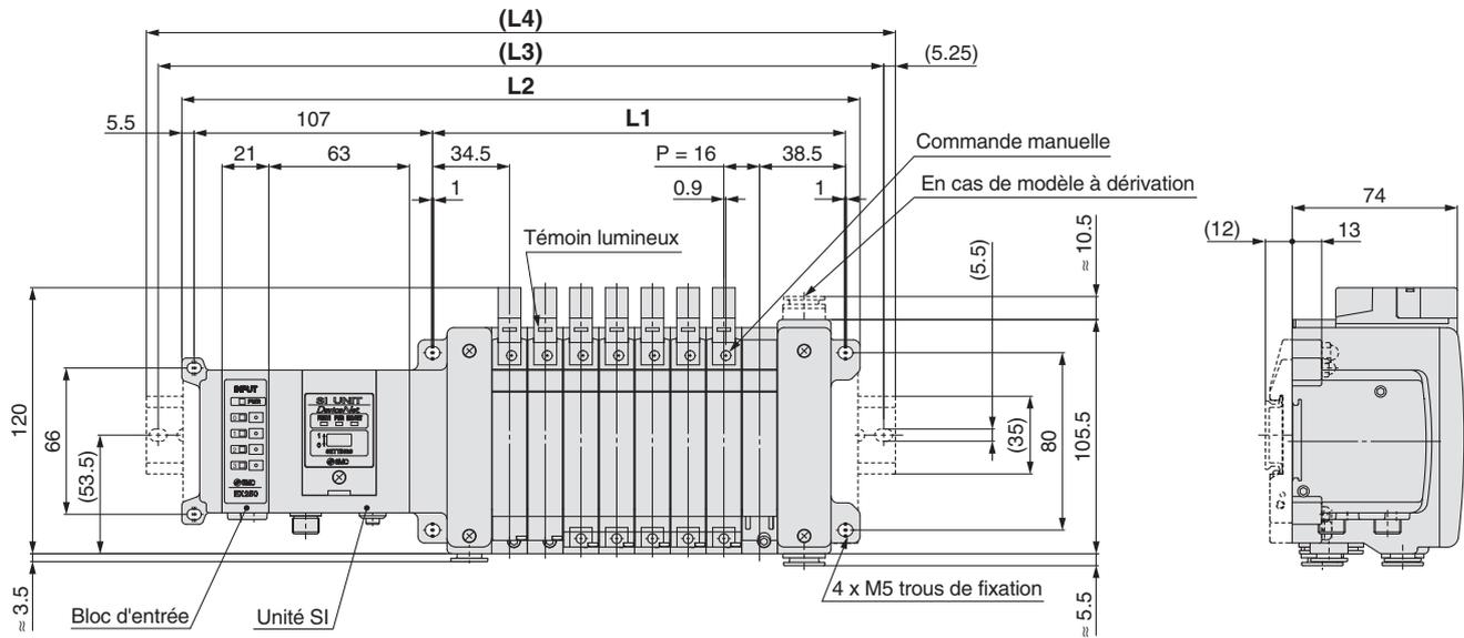
Les lignes en pointillés indiquent le montage sur rail DIN [-D] (avec fixation de montage pour rail DIN).
