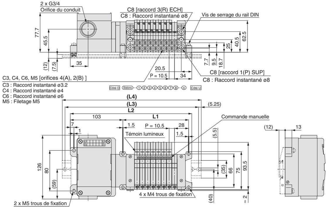
Les lignes en pointillés indiquent le montage sur rail DIN [-D] (avec fixation de montage pour rail DIN).
