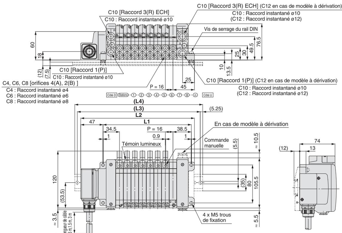
Les lignes en pointillés indiquent le montage sur rail DIN [-D] (avec fixation de montage pour rail DIN).
