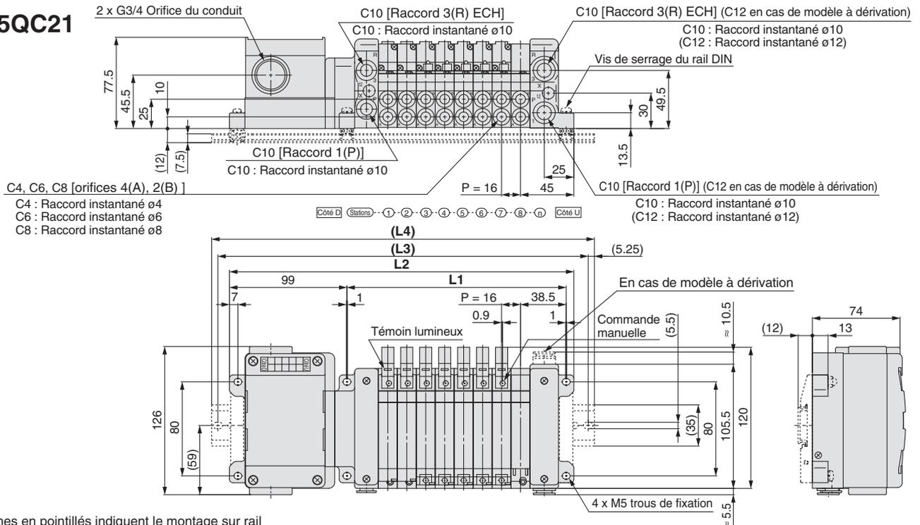
Les lignes en pointillés indiquent le montage sur rail DIN [-D] (avec fixation de montage pour rail DIN).
