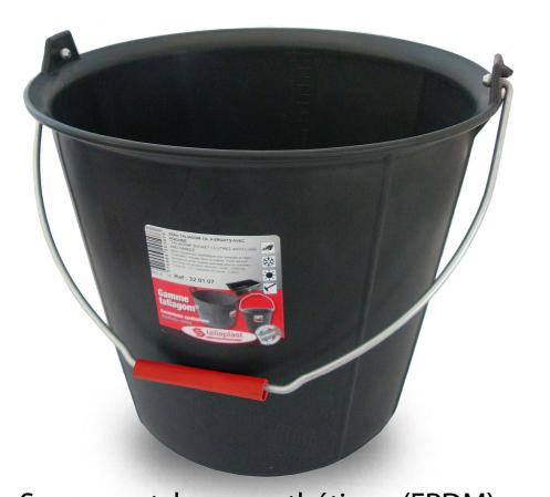
Seau caoutchouc synthétique (EPDM) très résistant et léger, résistant aux chocs et à tous types d'agression. Graduation moulée dans la masse. Fond nervuré facilitant la prise. Poids 0,85 kg environ. Parois avec nervures de renfort.
