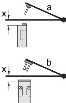
Le centre de rotation de la charnière doit être 30 mm plus haut que le bord supérieur de l'interrupteur de sécurité en formant un plan.
