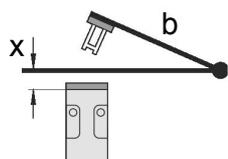
Le centre de rotation de la charnière doit être 30 mm plus haut que le bord supérieur de l'interrupteur de sécurité en formant un plan.
