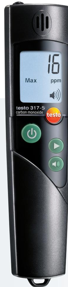
L'indicateur de CO ambient testo 317-5 signale toute présence de monoxyde de carbone par une alarme sonore et visuelle. Un appareil indispensable lors de vos opérations de maintenance de chaudières.
