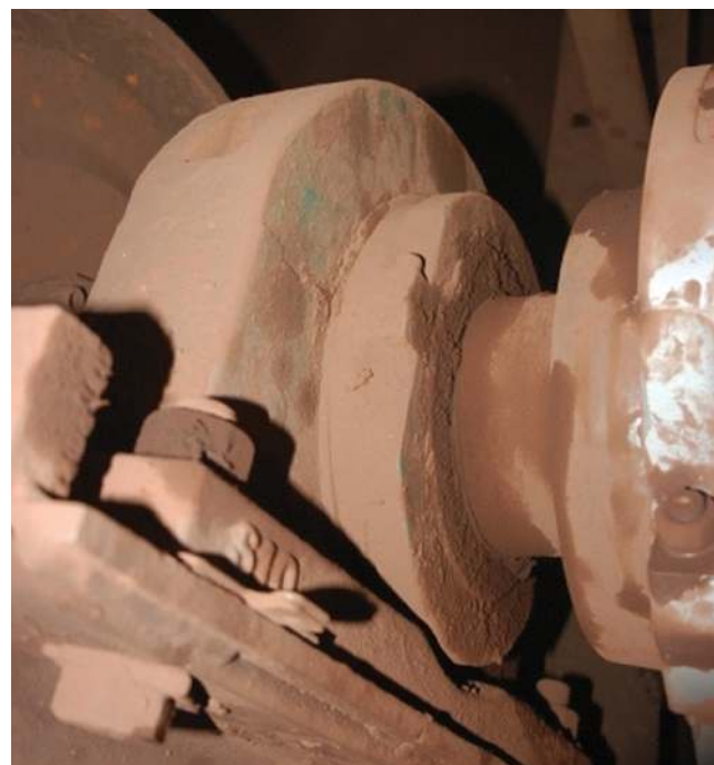
Figure 20. Palier à roulement à rouleaux cylindriques en deux parties Timken illustré dans une application sidérurgique.
