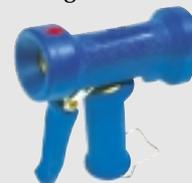
2° Pistolet avec corps en laiton chromé, revêtu d'EPDM bleu ou blanc, gachette revêtue d'EPDM isolant bleu ou blanc, rivets en inox et poussoir renforcé. Seul le pistolet blanc est équipé d'un arceau de protection de la gachette.
