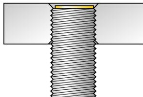
Tous les détecteurs cylindriques (13,56MHz) *uprox<sup>+</sup>* noyables permettent un montage encastré. Leur fonctionnement est garanti dans le cas d'un montage encastré d'un demi-millimètre.
