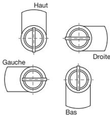
**Sens de rotation.** La clé peut-être retirée, soit uniquement dans la position F (standard) soit sur demande, dans les 2 positions F et O (à préciser lors de la commande).
