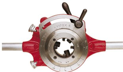
Cliquet en acier forgé traité, réversible sans démontage, pour filetage à droite et à gauche. Deux bras amovibles, en tube acier, vissables bout à bout.
