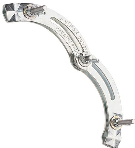
Appareil destiné au positionnement précis et rigide de deux tubes (ou profilés) à un angle choisi, pour leur assemblage. Assure une parfaite liberté de mouvement lors du soudage ou du brasage. Serrage par écrou à oreilles. Pièces zinguées.
