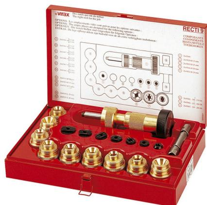
Appareil pour rectifier les sièges de robinets. Fraise permettant un usinage d'excellente qualité. Taraudage M8. Pièces en laiton. Contrôle micrométrique de l'avance. Contrôle sensitif permanent de l'usinage.
