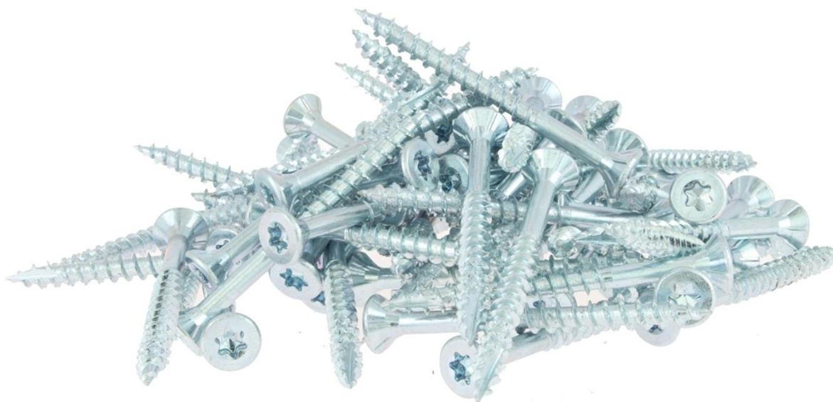
Vis bois et aggloméré technique avec ailettes de fraisage sous tête et pointe cutting anti-éclatement. Son filet en dent de scie permet un défibrage efficace du bois pour une meilleure pénétration.
