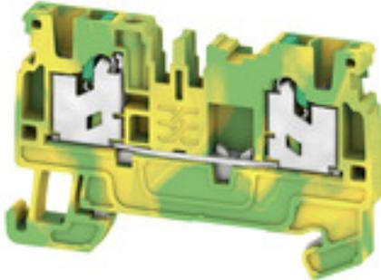
Un bloc de jonction de passage protecteur est un conducteur électrique de sécurité et est utilisé dans de nombreuses applications. Pour établir la connexion électrique et mécanique entre les conducteurs de cuivre et la plaque de support de montage, on utilise des blocs de jonction PE. Ils disposent d'un ou de plusieurs points de contact pour la connexion et/ou la dérivation de conducteurs de terre protecteurs.
