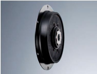
Le MONOLASTIC® est un accouplement monobloc en caoutchouc naturel, élastique en torsion. Le moyeu acier prémonté en usine présente une denture intérieure traitée qui permet un montage axial de la pompe hydraulique. Accouplement disponible avec différents types de cannelures SAE ou DIN.
