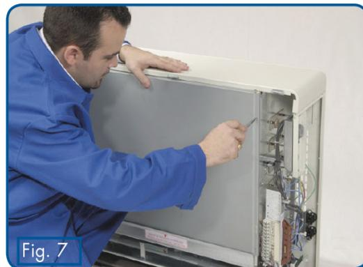
Retirer le chausse-isolant (1) et la pièce de fixation murale (2) et les garder à disposition. Retirer les 4 vis de fixation du panneau de fermeture.
