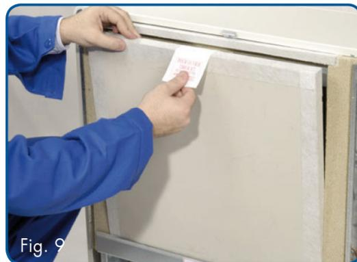
Retirer le panneau de fermeture en l'inclinant vers soi puis en le soulevant. Désengager l'isolant avant en tirant doucement sur la feuille de plastique. Retirer l'isolant en le tirant vers le haut.
