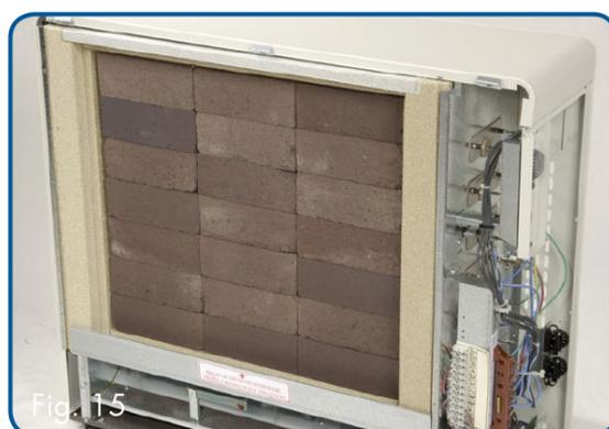
Utiliser cette technique pour le reste des briques. Il peut exister un léger espace entre les briques et l'isolant supérieur. Sur les modèles 4,5 kw et 6 kw, épaisseur 445 mm, remettre en place le chapeau isolant au dessus des briques.
