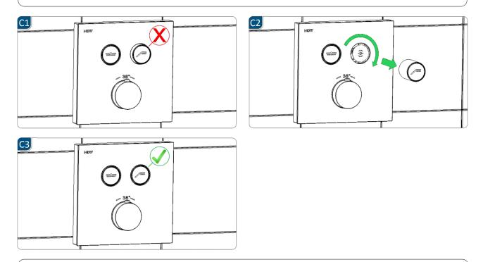
Seconde possibilité pour réglage hauteur du bouton poussoir, pour être à l'aplomb de la plaque lorsque la valve est fermée.
