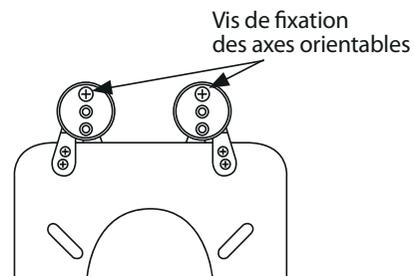
Desserrer légèrement les vis de fixation des axes orientables.
