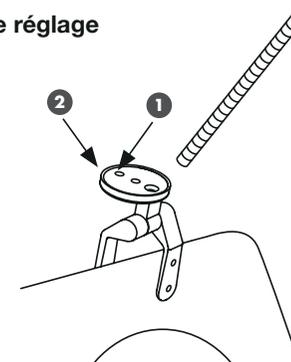
Visser la tige filetée soit dans le trou fileté n°1 soit dans le trou fileté n°2 afin d'ajuster l'abattant et recouvrir la cuvette.
