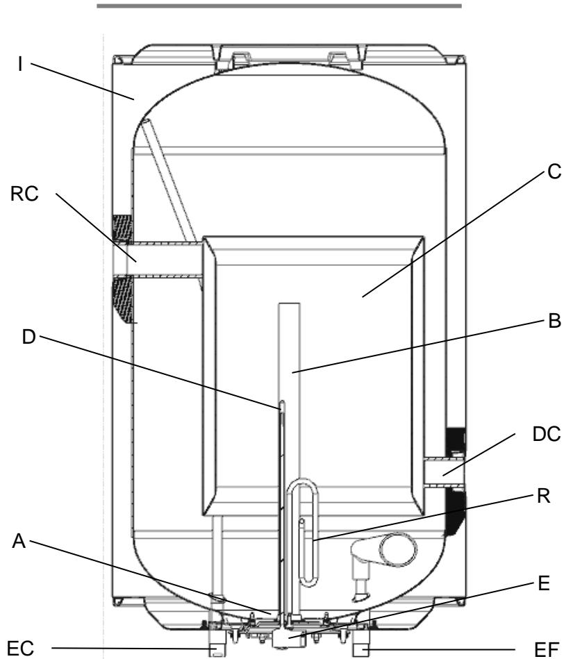
**A** Trappe de visite/Toegangflens / Brida de inspección / Klapa rewizyjna / Pozzetto di ispezione
