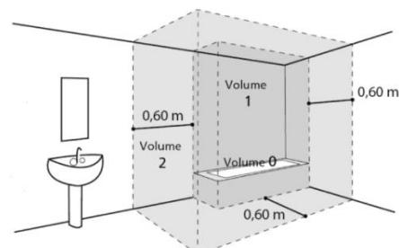
4/ W przypadku montażu urządzenia w łazience, nie wolno instalować go w strefie V0 i V1 (zob. wykres 1). Jeśli w łazience nie ma wystarczająco dużo miejsca, można zainstalować urządzenie w strefie V2 lub, w przypadku modelów poziomych, w strefie V1 jak najbliżej sufitu.
