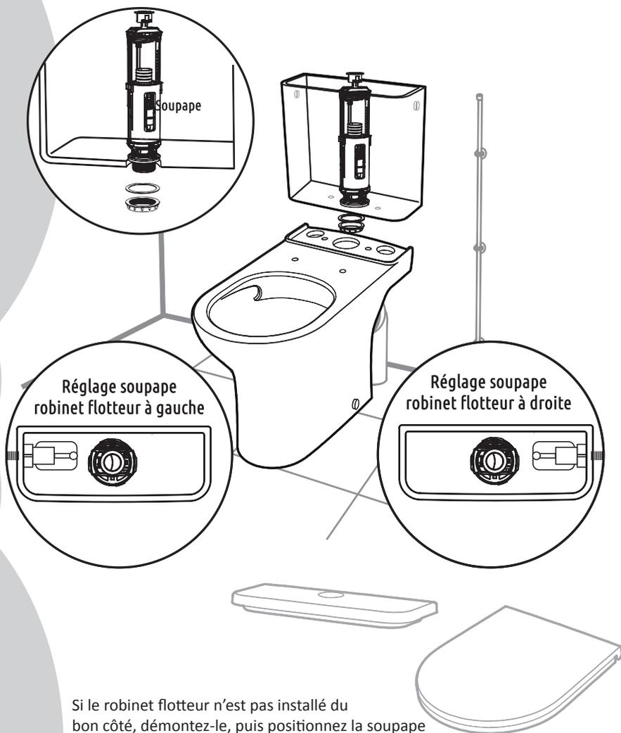
Si le robinet flotteur n'est pas installé du bon côté, démontez-le, puis positionnez la soupape du mécanisme du côté souhaité (côté gauche ou droit) en fonction de votre installation, du montage du robinet flotteur et de votre arrivée d'eau.
