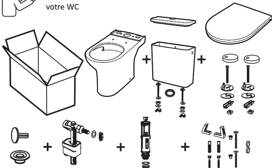
Mécanisme de chasse et robinet flotteur déjà installés dans le réservoir.
