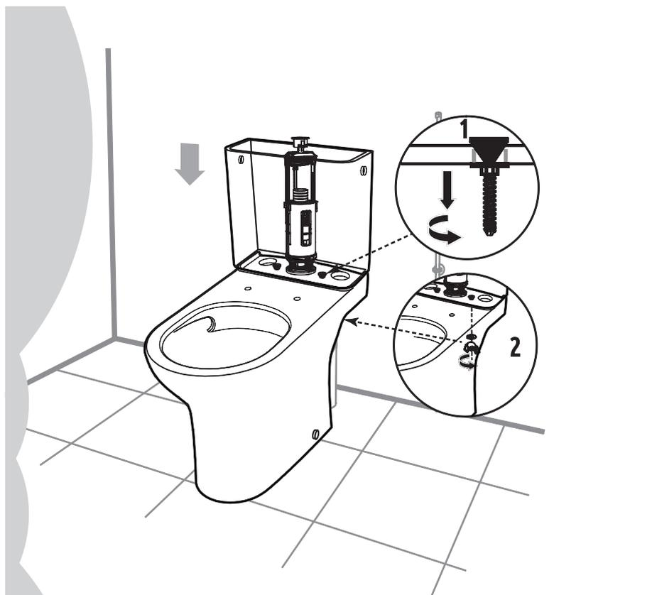
Placez les écrous sous la cuvette
