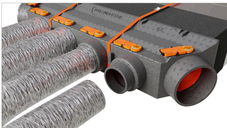
La forme légèrement cônique des piquages facilite grandement l'encaissement de la gaine. Répétez l'opération pour les autres piquages à raccorder.
